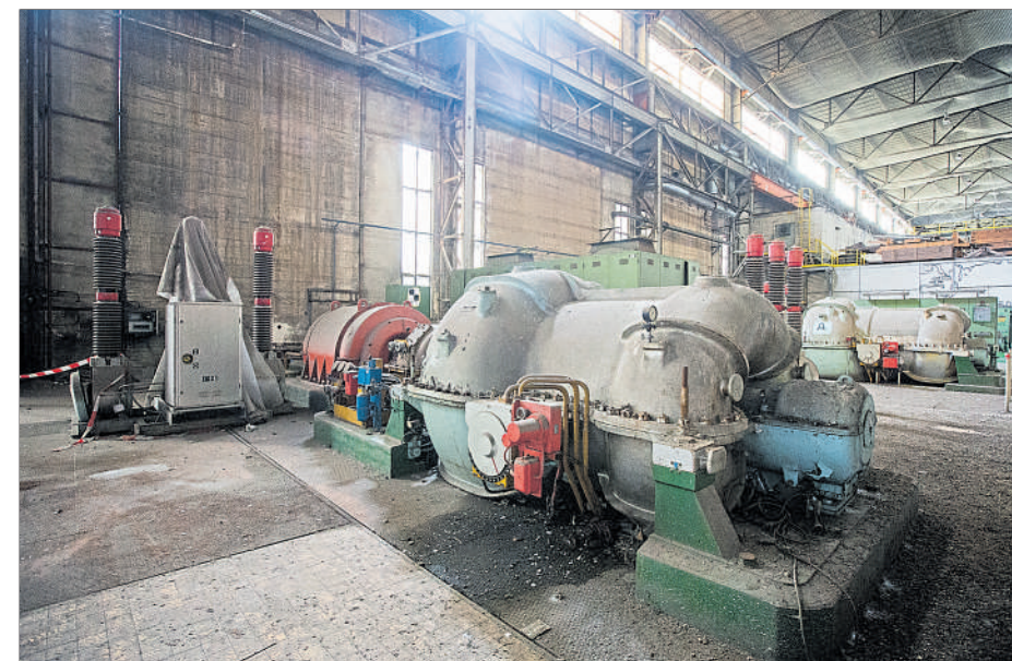
Einst waren Gichtgaskolbenmotoren für die Windproduktion in der Gebläsehalle zuständig. Mit dem Bau der neuen Hochöfen generation mussten sie Turbokompressoren weichen. Foto: Amicale des Hauts-Fourneaux
